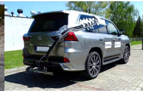
PEMS testing (incl. RDE)
