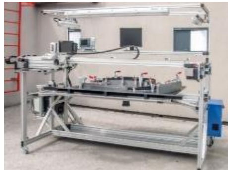
Stanowisko do kontroli uszczel z funkcją automatycznego zapisu i transmisji danych
