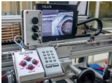
Stanowisko do kontroli uszczel z funkcją automatycznego zapisu i transmisji danych
