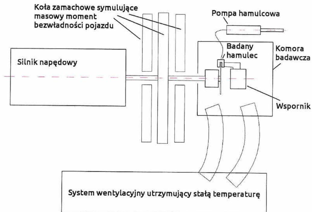
Rysunek nr 1 Schemat ideowy konfiguracji stanowiska
